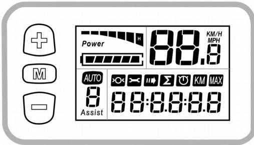
Krátkým stisknutím tlačítka **M** (vlevo, uprostřed) **zapnete** napájení motoru elektrokola. Dlouhým stisknutím tlačítka **M** (vlevo, uprostřed) **vypněte** napájení motoru elektrokola.
